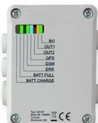
**Модуль GSM, DA-ETR-107** - очень простое расширение, позволяющее послать в случае возникновения какой-либо аварийной ситуации сообщение SMS на 1- 6 номеров , или сообщение на адрес электронной почты. Сообщение содержит тип и серийный номер оборудования.
