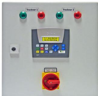
**Система компаундного управления DA-CM1-230** используется для управления двумя осушителями при 100% резервировании. Осушители могут включаться поочередно, обеспечивая равную наработку. Все осушители, имеющие "удаленный старт - стоп" или "контакт синхронизации компрессора", могут быть непосредственно связаны с системой компаундного управления и управляться ею без потребности в модификациях.
